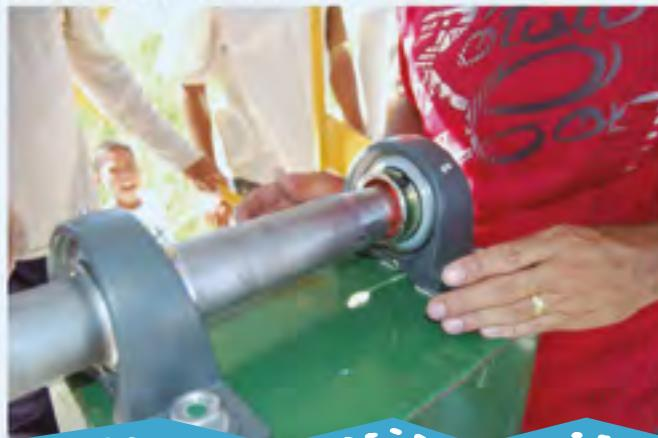
Foto 21 – Montagem do volante no pedestal
