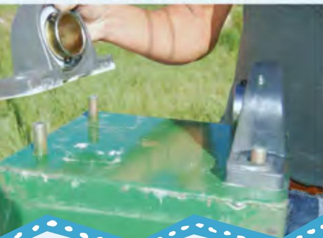
Soltar os parafusos dos mancais que travam o eixo. O eixo deve girar livremente (foto 20). Do contrário, remover com uma lixa o que está impedindo: pode ser tinta, oxidação ou sujeira. Posicionar o eixo e apertar os parafusos.
